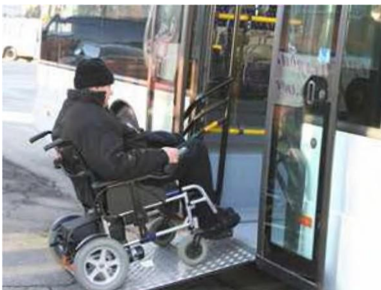
Рисунок 7 Организация посадки в низкопольный автобус инвалида-колясочника
